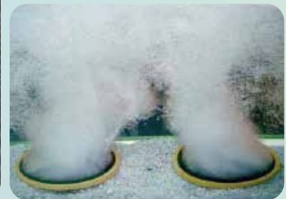
Uso en aireación de efluentes líquido con difusores a membrana
