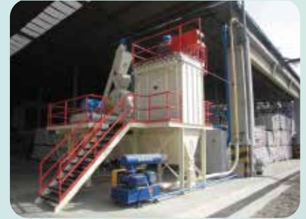
Uso en transporte neumático por presión positiva
